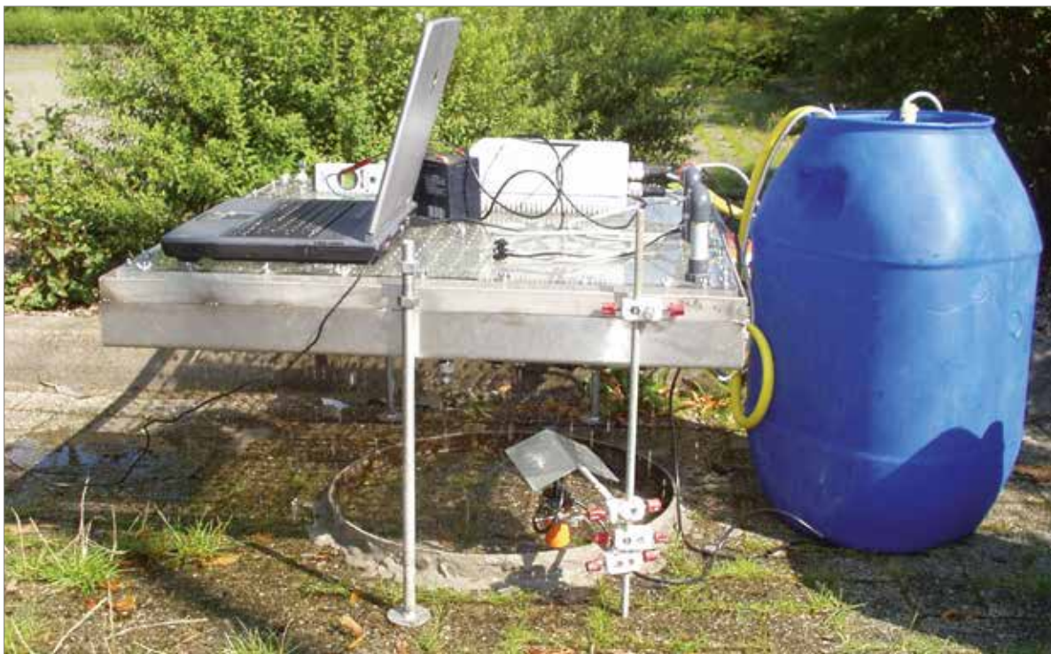
Versickerungsmessung an einer Bestandsfläche mittels Tropfinfiltrimeter.
