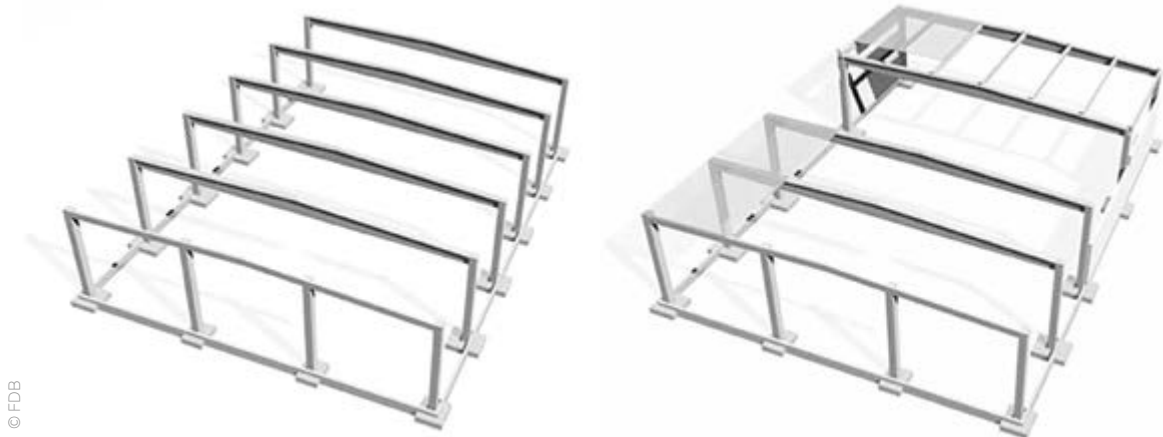
Typische Hallentragkonstruktionen: Binderkonstruktion (links), Pfetten-Binder-Konstruktion (rechts).
