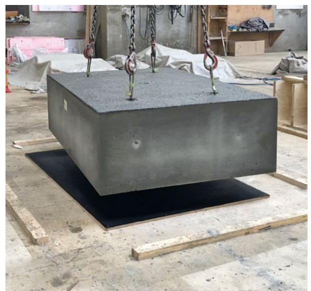
Prüfplatte zur Untersuchung der Frühfestigkeit von Infralichtbeton.
