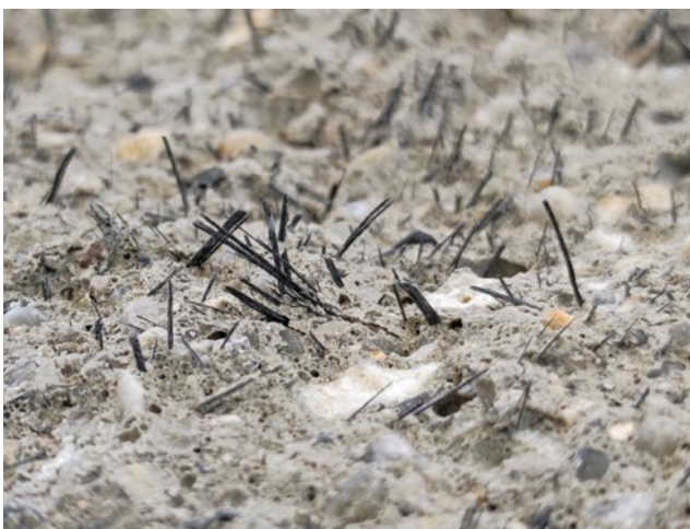
Die Nahaufnahme zeigt deutlich die Kohlenstofffasern im Bruchbereich nach dem Biegeversuch.
