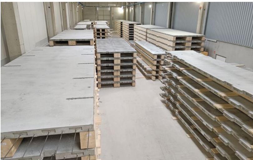
Lagerung der fertigen HB-Verbunddecken.
