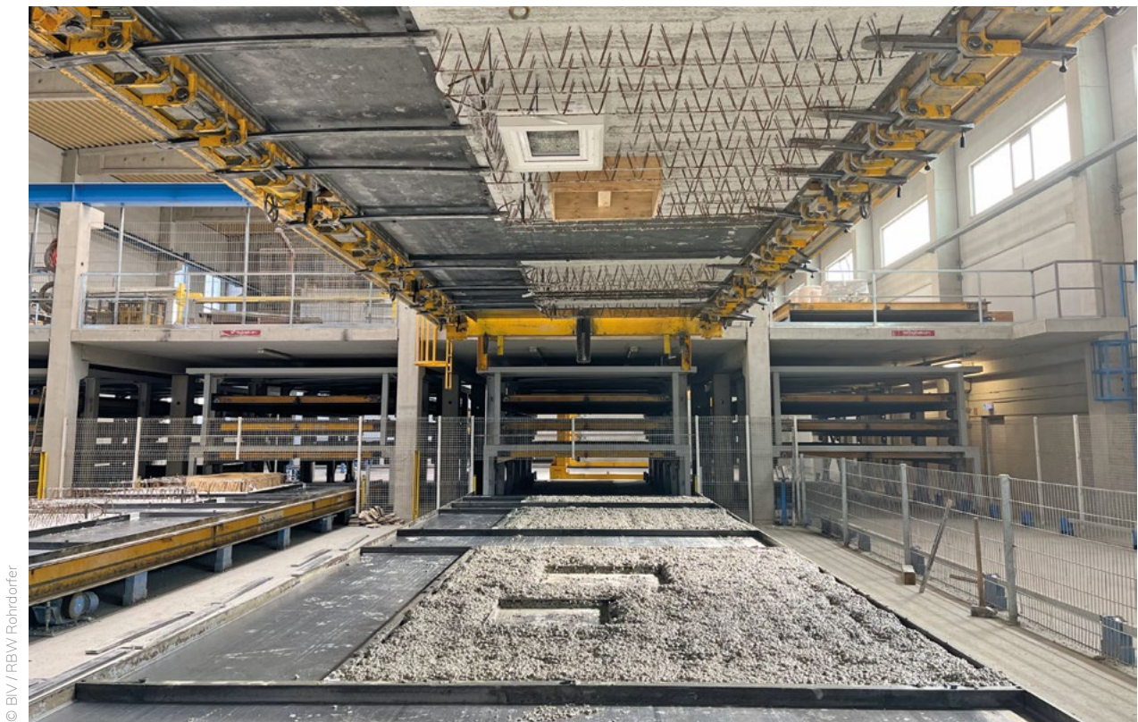
Produktion von Fertigteilwänden bei RBW Rohrdorfer.
