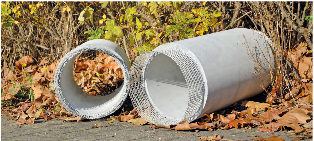
Textilbetonstrukturen mit integrierter Leckagesensoren.
