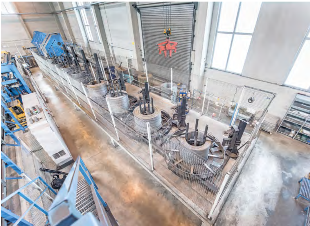
Automatisierte Stahlspulen sorgen für die kontinuierliche Versorgung der Decken- und Wandelemente mit Bewehrung.
