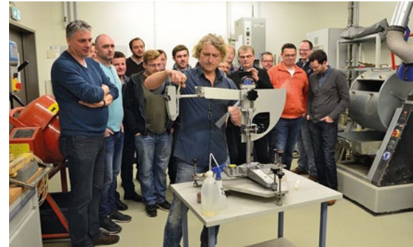
Im Rahmen des Praxis-Blocks demonstriert Dr. Mike Wolf im Labor der TU Dresden die Funktionsweise des SRT-Pendelgeräts
