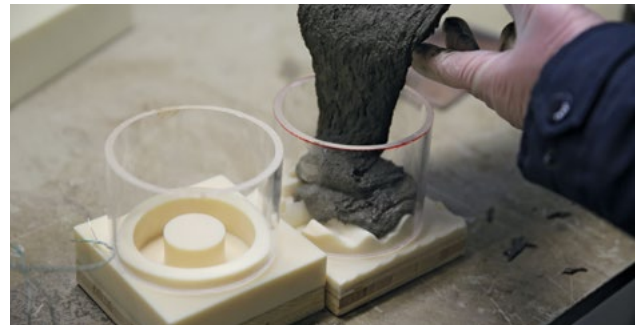
"Non-Waste-Wachsschalungen" Neuartige Präzisions-Schalungen aus 100 % recycelbaren Industrie-Wachsen zur Herstellung von geometrisch komplexen Beton-Bauteilen
